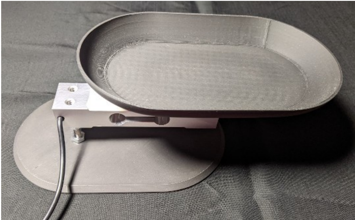
Immagine della cella di carico con la base e il piatto eseguiti con una stampante 3D
