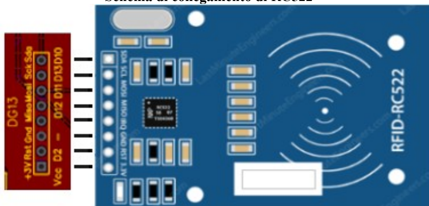
Il modulo RFID 522 si connette nativamente sullo zoccolo DG13
