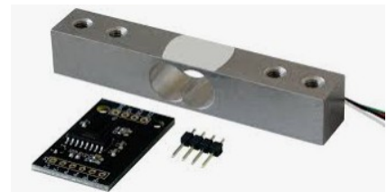
La cella di carico + amplificatore HX711 (deve essere collegata con un cavetto – piedinatura differente)
