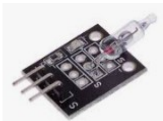
KY-017 mercury tilt module
