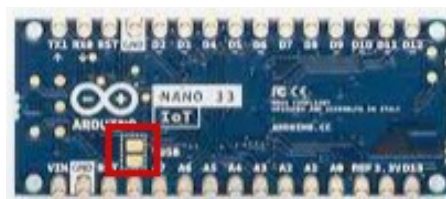
Il punto dove effettuare la saldatura
