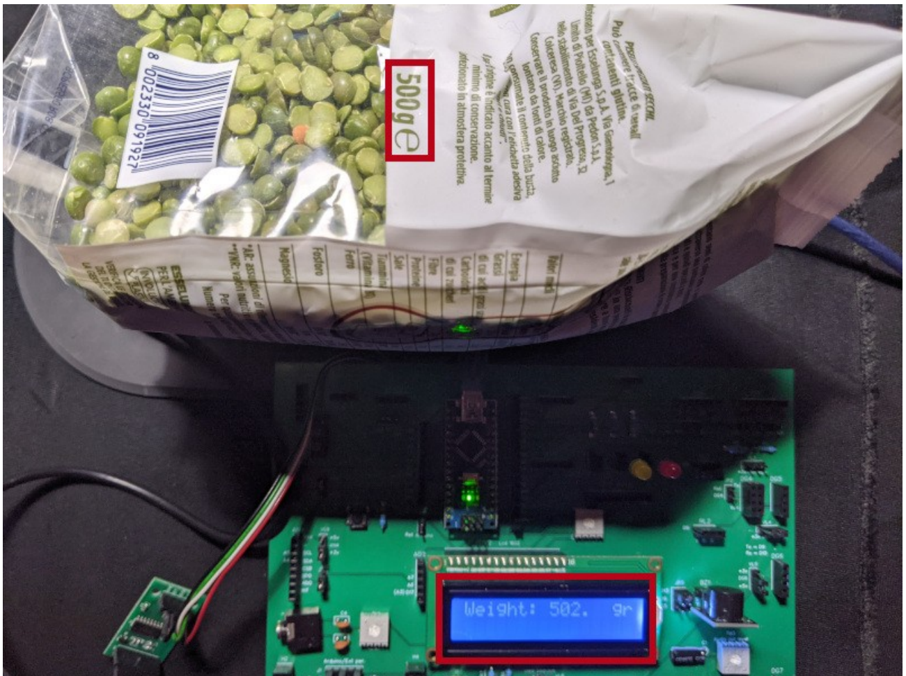
Il risultato ottenuto con il programma “pesa”; naturalmente si può perfezionare migliorando la calibratura fine del programma
