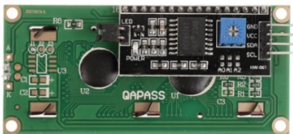
vista posteriore del display LCD 1602 con adattatore I2C
