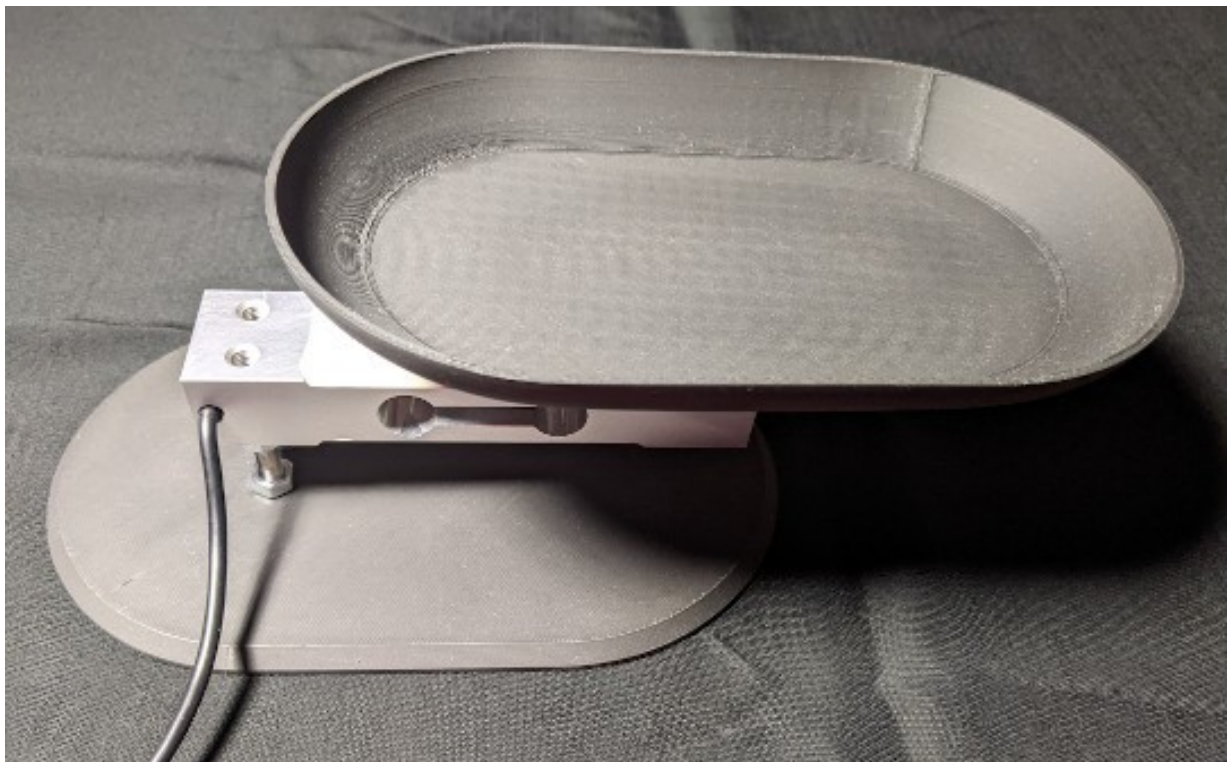
La struttura sperimentale della “bilancia” effettuata con una stampante 3D
